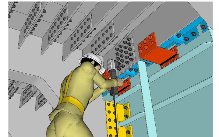
鋼床版相互、縦リブ、横リブをボルト接合
